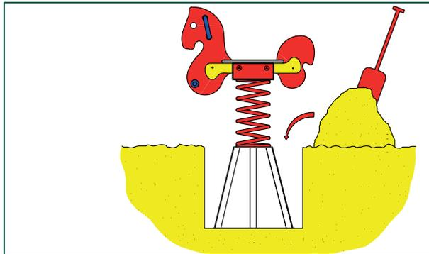
Spielgerät inklusive Anker in das Loch einsetzen; dabei ist darauf zu achten, dass die Oberkante des Anker mit der Oberkante des Boden abschließt.
