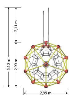
max. freie Fallhöhe: 1,65 m min. Fallschutzfläche: 36,25 m<sup>2</sup> min. Fallschutzumfang: 22,68 m
